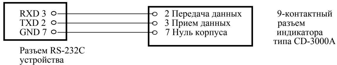
Схема соединения с принтером серии CP-7000:
