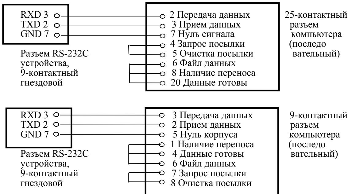
Схема соединения с выносным индикатором:
